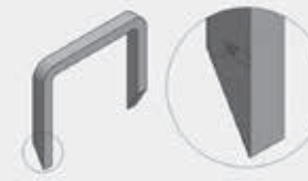
DR-Schnitt Sägeschnitt (Spitze nach rechts)
