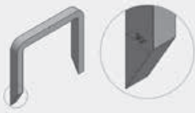
DL-Schnitt Sägeschnitt (Spitze nach links)
